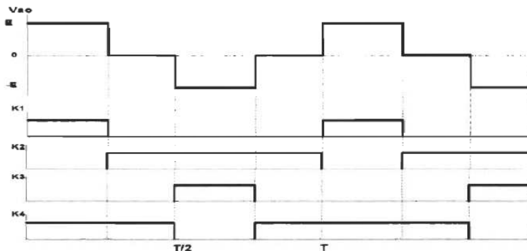
Figure II.5 Formes d'ondes d'un bras d'onduleur triphasé de type H
